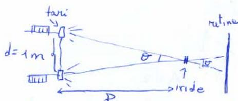
infatti il massimo centrale della figura di diffrazione di un foro cadrebbe sul primo minimo della figura dell'altro.
