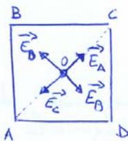
$\vec{E}_A$  e  $\vec{E}_C$  hanno direzione lungo la diagonale AC e versi opposti (le cariche sono entrambe positive). Poiché le cariche in A e C sono uguali e  $\overline{AO} = \overline{CO}$ , allora anche i moduli  $|\vec{E}_A|$  e  $|\vec{E}_C|$  sono uguali.
