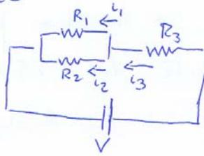
$R_1$  e  $R_2$  sono in parallelo e quindi equivalgono ad una resistenza
