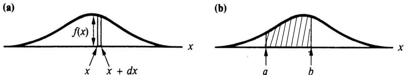
**Figura 5.5.** Una distribuzione limite  $f(x)$ . (a) Dopo molte misure la frazione che cade fra  $x$  e  $x + dx$  è l'area  $f(x)dx$  della stretta striscia. (b) La frazione che cade fra  $x = a$  e  $x = b$  è l'area ombreggiata.
