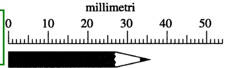
**Figura 1.2.** La misura di una lunghezza con un righello.
