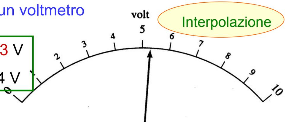
**Figura 1.3.** Una lettura su un voltmetro.
