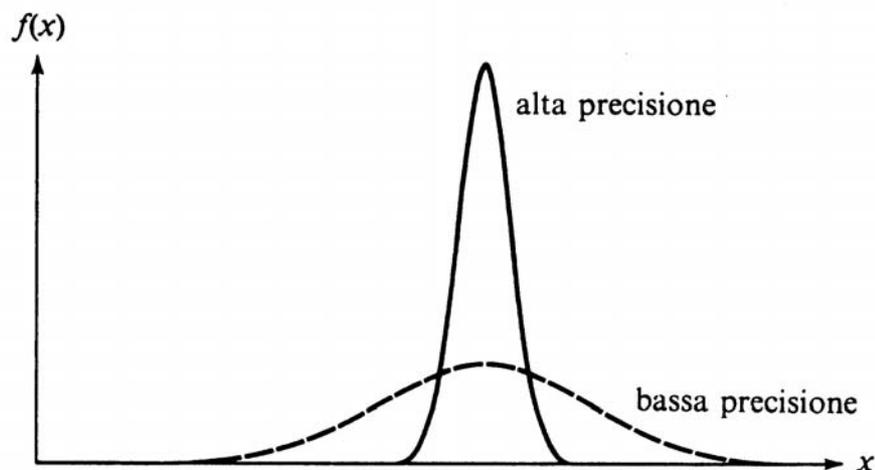
**Figura 5.6.** Due distribuzioni limite, una per una misura ad alta precisione, l'altra per una misura a bassa precisione.
