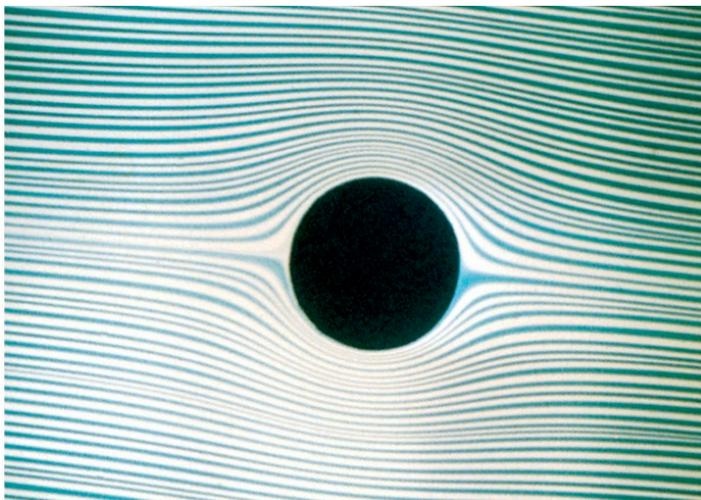
Moto laminare in un fluido, messo in evidenza con un tracciante colorato.
