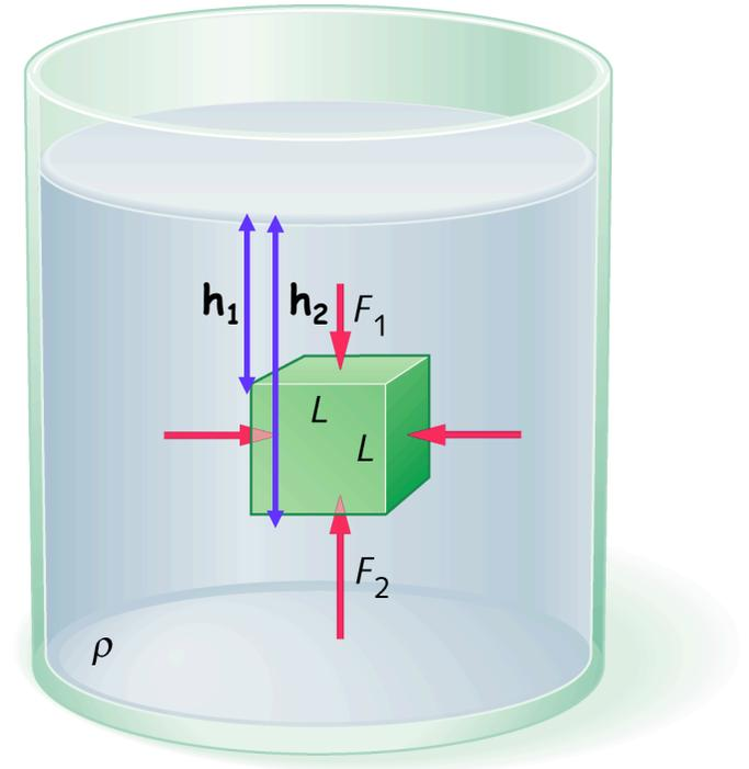
peso del liquido "spostato", non del corpo immerso!
