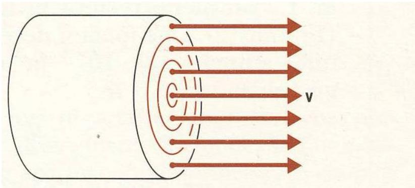
In un fluido **ideale** (non viscoso) tutte le particelle di fluido in una sezione trasversale del tubo hanno la stessa velocità.
