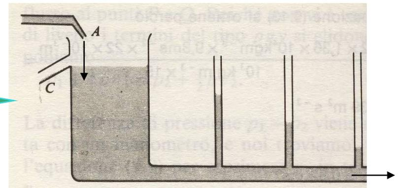
La perdita di carico in un fluido viscoso dimostra che c'è dissipazione di energia
