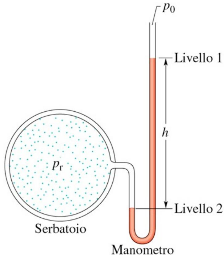
La differenza tra la pressione del gas nel serbatoio e la pressione atmosferica è proporzionale all'altezza del fluido nel tubo ad U
