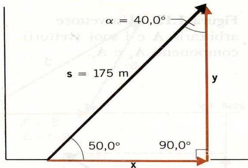
**Figura 1.15.** I componenti  $x$  e  $y$  del vettore spostamento  $s$  si possono trovare usando la trigonometria.
