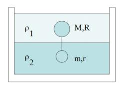
c'è la sfera più piccola il corpo è in equilibrio; se invece c'è quella più grande, il corpo comincia a traslare con un'accelerazione verticale ascendente di modulo a. Determinare le densità dei due fluidi, sapendo che r=7 cm, m=2.3 kg, R=11 cm, M=3.8 kg ed a=0.6 m/s<sup>2</sup>.
