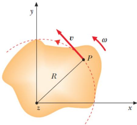
Moto di pura rotazione. Dato che la distanza fra ogni coppia di punti del corpo è fissa, il moto dei punti è circolare con velocità angolare  $\omega$ . Le traiettorie sono archi di circonferenza giacenti su piani paralleli con centro sull'asse di rotazione.
