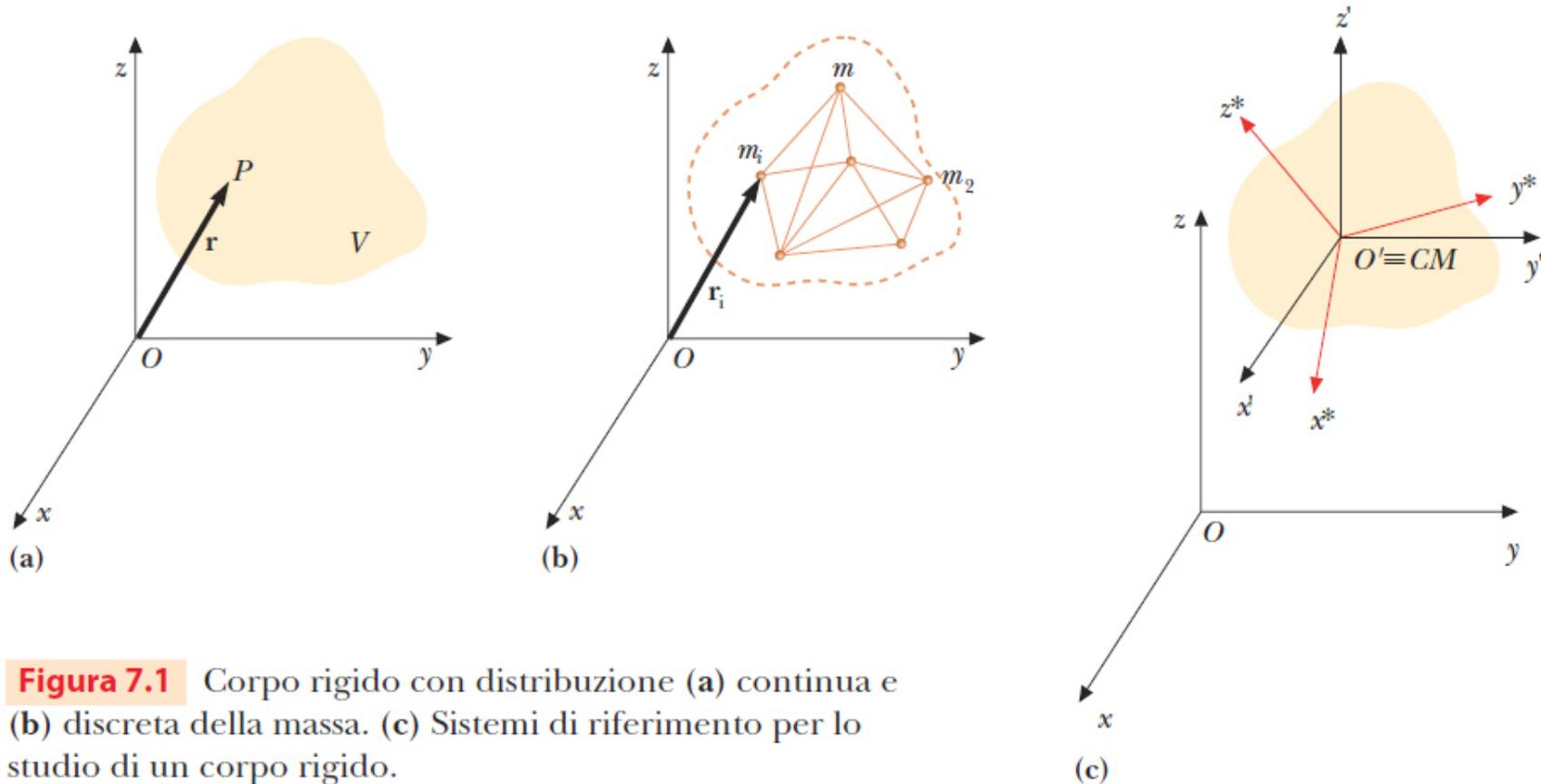
**Figura 7.1** Corpo rigido con distribuzione (a) continua e (b) discreta della massa. (c) Sistemi di riferimento per lo studio di un corpo rigido.
