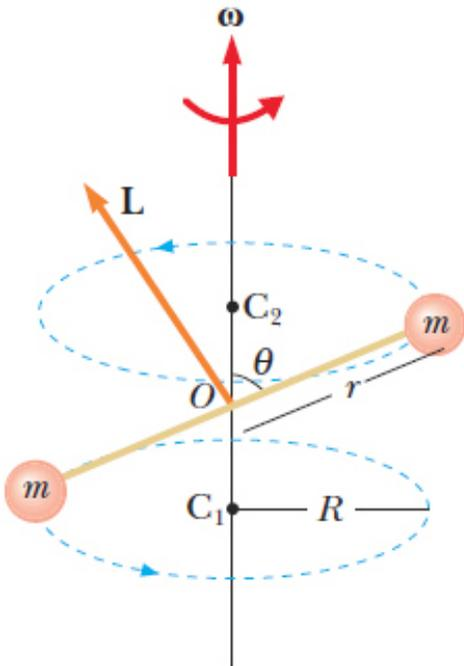
Corpo rigido in moto rotatorio uniforme attorno ad un asse non principale di inerzia
