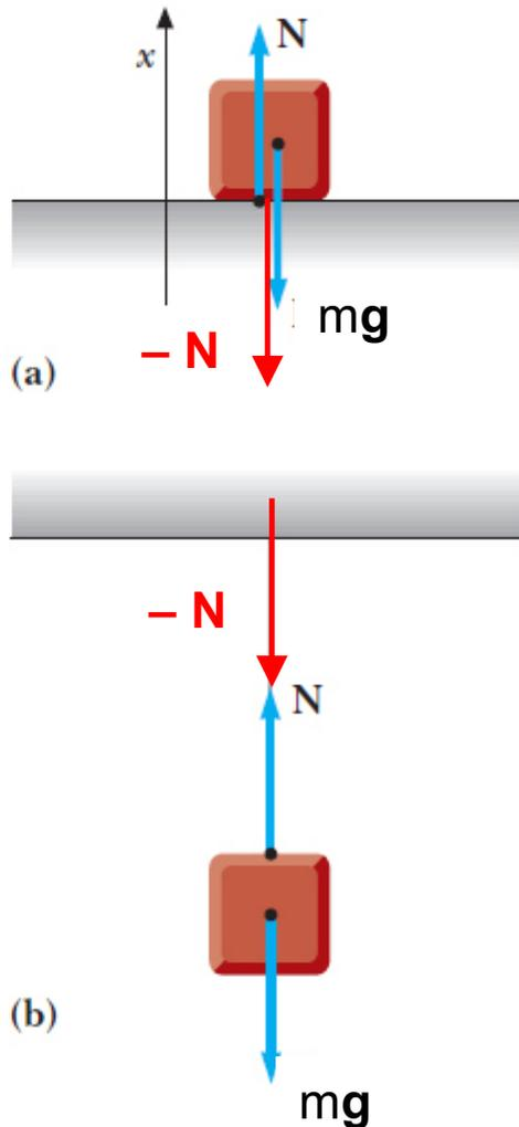
$\mathbf{N}$  è la reazione del vincolo (il piano di appoggio o il soffitto nei casi in figura) sull'oggetto di massa  $m$ , che gli impedisce di cadere per effetto della forza peso  $mg$ .
