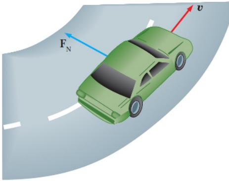
L'auto percorre la curva circolare di raggio  $r$  senza sbandare se la forza centripeta è data dall'attrito statico (perché non c'è spostamento radiale) fra i pneumatici e l'asfalto.
